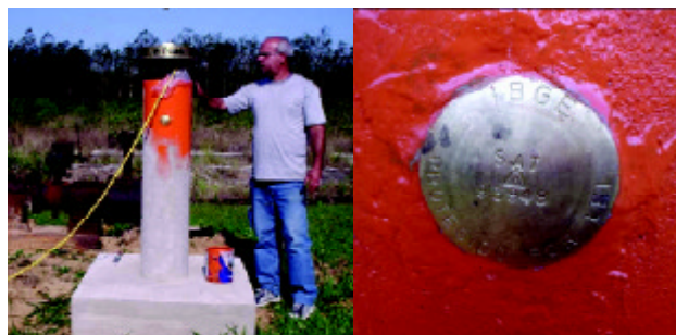
Medição e padronização da estação geodésica SAT 93.948
