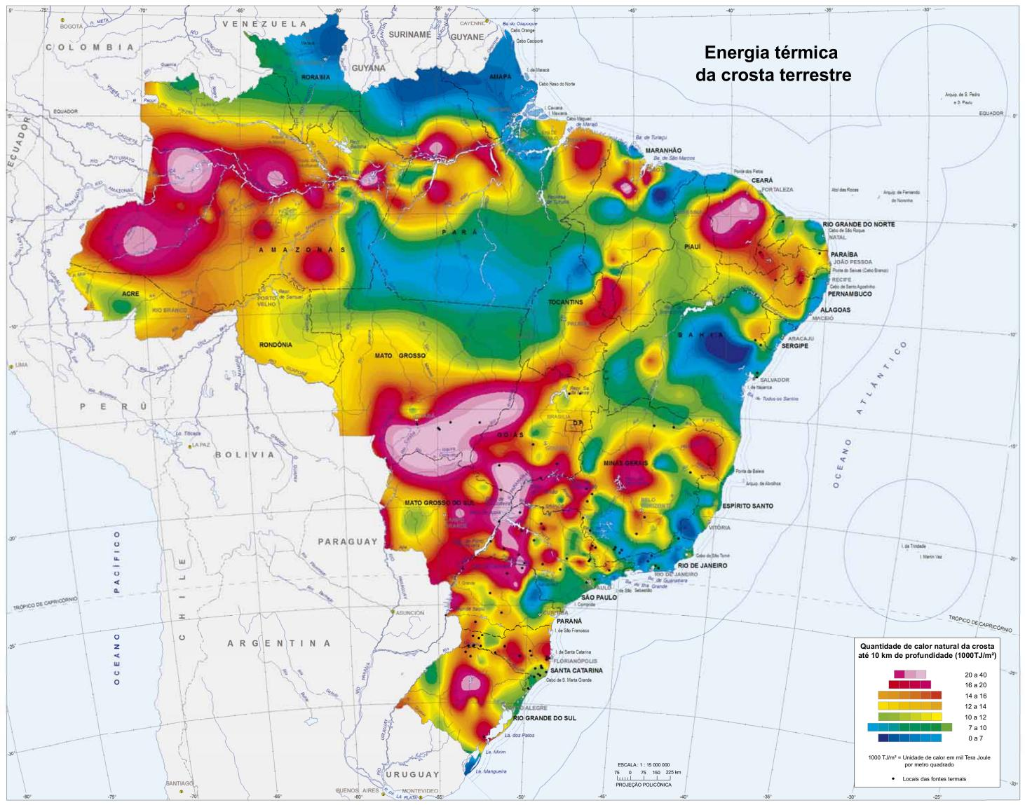
Fonte: Observatório Nacional, Coordenação de Geofísica, Laboratório de Geotermia. Notas: 1. Recurso base: energia térmica em profundidade de até 10km. 2. As áreas em vermelho indicam locais de energia térmica mais elevada, consideradas como alvo para exploração.
