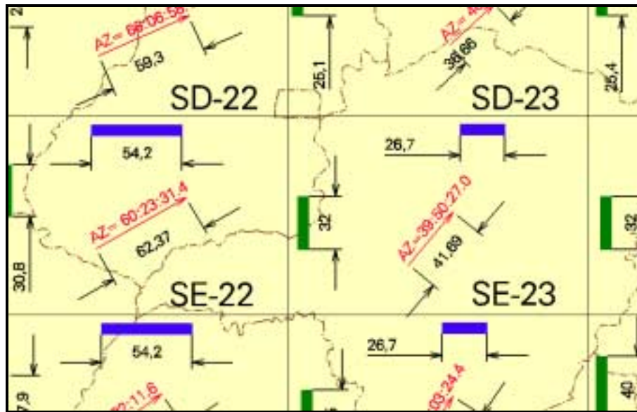
Figura h . Comportamento do deslocamento horizontal entre cartas Córrego Alegre e SIRGAS -Detalhe
