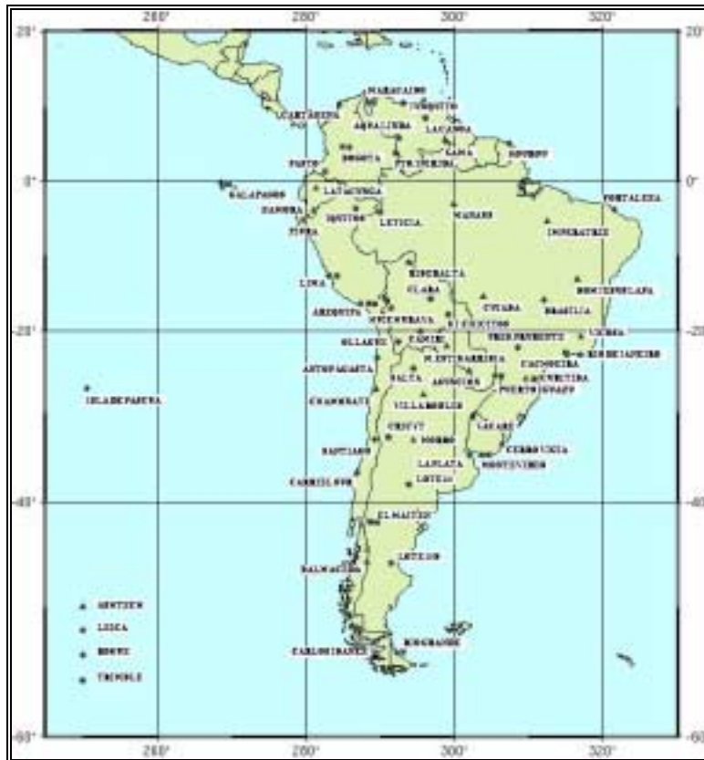
Figura b. Rede SIRGAS (Sistema de Referência Geocêntrico para América do Sul). Os diferentes símbolos representam os vários receptores GPS utilizados durante a campanha SIRGAS95
